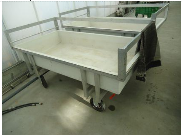
№ п/п 52, инв. № 80, Тележки. «А»-образные тележки из нержавеющей стали - 22 шт. - используются для первичной транспортировки цветов от «среза» по междурядью посадок. Тележки-ванны эмалированные - 15 шт., используются для перемещения и сохранности цветов (с водой на дне).
