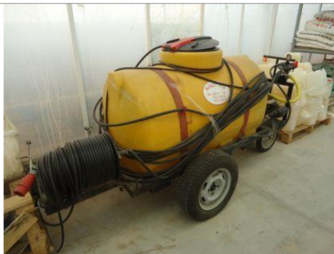
№ п/п 30, инв. № 43, Опрыскиватель ОЗГ-750, для обработки растений химикатами, объём ёмкости 750 л.
