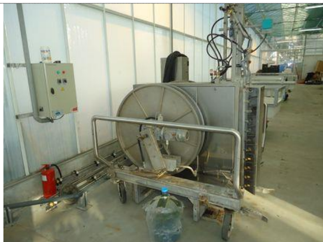
№ п/п 56, инв. № 68, «Установка для распыления» - автоматическая установка для распыления химикатов Micothon BR Mark II
