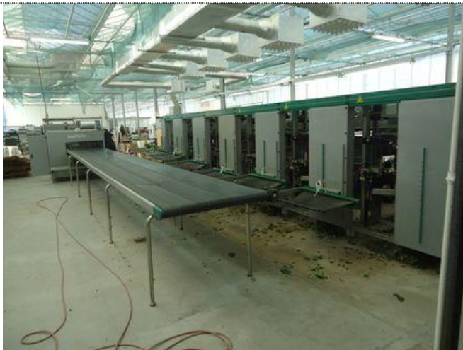
№ п/п 29, инв. № ЦБ64, Оборудование для перемещения цветов - конвейерная линия с транспортёром-упаковщиком букетов
