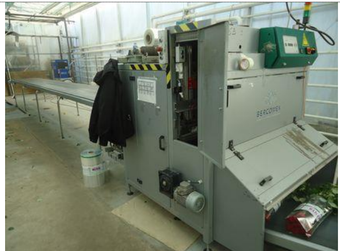
№ п/п 29, инв. № ЦБ64, Оборудование для перемещения цветов - конвейерная линия с транспортёром-упаковщиком букетов
