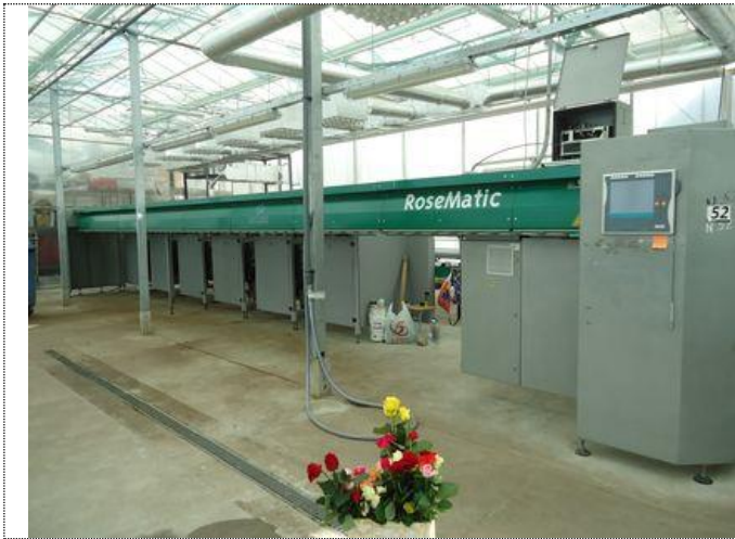
№ п/п 51, инв. № 63, Сортировочная машина. Технологическая линия для сортировки и подрезки роз RoseMatic Bercomex Horti & Agro Solutions с системой управления Beckhoff
