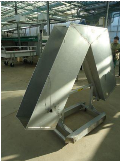
№ п/п 52, инв. № 80, Тележки. «А»-образные тележки из нержавеющей стали - 22 шт. - используются для первичной транспортировки цветов от «среза» по междурядью посадок. Тележки-ванны эмалированные - 15 шт., используются для перемещения и сохранности цветов (с водой на дне).
